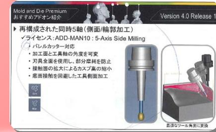
Новый метод фрезерования разработан с учетом CAD/CAM "софта".
